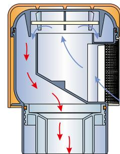
При возникновении разрежения в стояке (более 5 мм вод. столба) клапан открывается и пропускает воздух в стояк, а при выравнивании давления снова закрывается.
