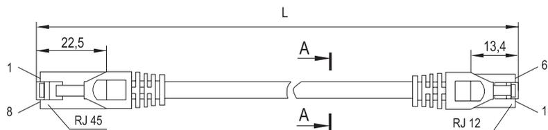
Патч-корды RJ45-RJ12 используются для коммутации соединения кабельных линий патч-панелей и активного сетевого оборудования между собой. Шнуры состоят из отрезка патч-кабеля, оконцованного с одной стороны разъемом RJ45/8P8C, а с другой стороны разъемом RJ12/6P6C.
