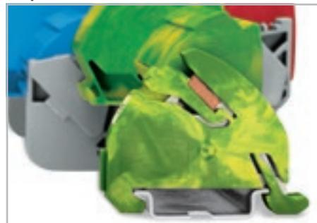
Держатель включает розетку с блокировкой для сборной шины 10 x 3 мм. Контакт между сборной шиной и рейкой устанавливается автоматически после установки ее на защелку на рейку DIN 35. Один конец шины устанавливается на держатель шины с заземлением, второй вставляется в среднюю часть изолированного держателя шины.
