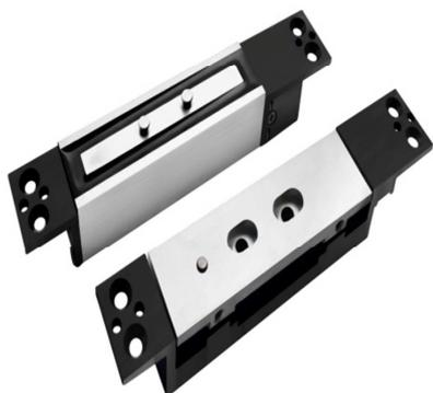
Врезной, сдвиговый электромагнитный замок **Falcon Eye FE-L1200** для всех типов дверей. Возможность установки замка в горизонтальном и вертикальном положении. Автоматический выбор напряжения 12/24В. Усилие на сдвиг 1200кг. Встроенная плата задержки с регулировкой открытия от 0,5 сек до 25 сек. Встроенный датчик положения двери. Индикация открытия/закрытия. Так же в комплекте с замком прилагается планка.
