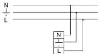
2. Схема підключення світильника до мережі живлення з блоком резервного живлення.
