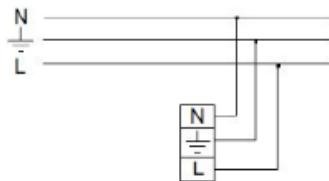
2. Схема подключения светильника к питающей сети с блоком резервного питания.
