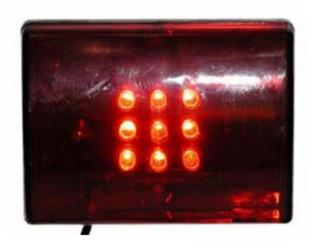
включаются ряд сигнальных оптических индикаторов красного или желтого цвета. При неправильно сфазированной подаче питающего напряжения на оповещателе включается отдельный оптический индикатор зеленого цвета. Оповещатель выпускается с красным свечением сигнального цвета (запрещение, непосредственная опасность) и с желтым свечением сигнального цвета (предупреждение, возможная опасность).
