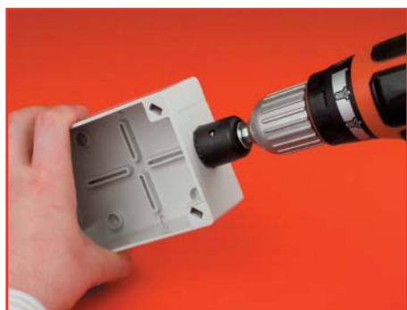
Сверлим отверстия необходимого диаметра
