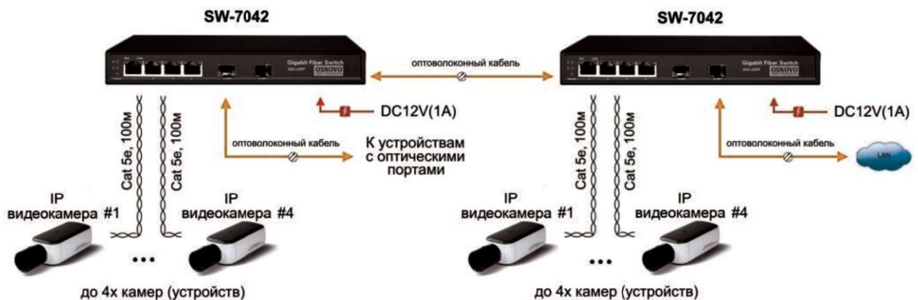
Рис.5 Схема каскадного подключения коммутатора SW-7042
