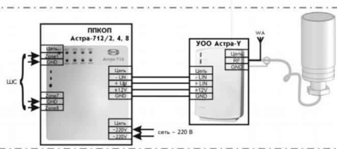
Передатчик системы Астра-У, используемый в автономном режиме для передачи информации о состоянии встроенных 2-х ШС на удаленный пост охраны
