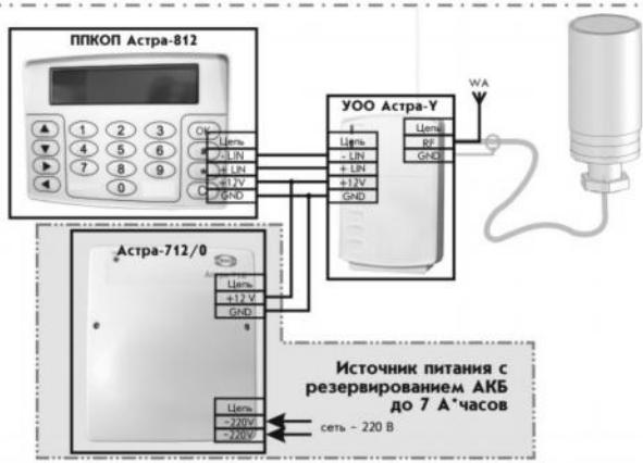
Передающая часть системы Астра-У, для передачи информации о состоянии ППКОП Астра-712/х проводной ОПС объекта на удаленный пост охраны
