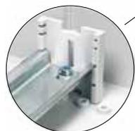
Возможность монтажа устройств различной глубины путем перемещения DIN-рейки в тот или иной паз (47, 54, 64, 74 мм)
