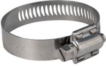
Ширина 12,7 мм. Усиленная конструкция замка препятствует его разрушению при затяжке. Для тонкостенных шлангов и соединений, находящихся в условиях низких и средних давлений и вибраций. Материал: нержавеющая сталь.
