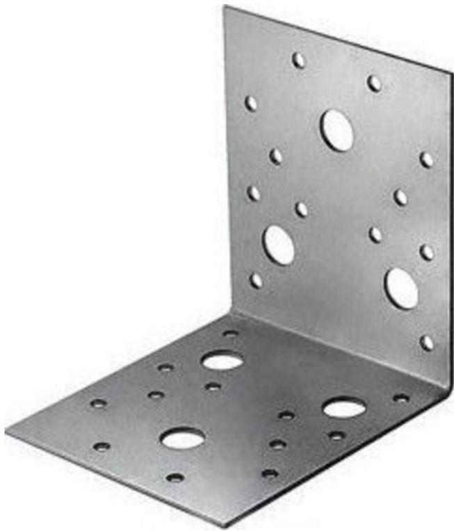
Применяются для соединения различных деревянных конструкций под углом  $90^\circ$ . Может использоваться для монтажа деревянных стоек прямоугольного сечения к бетону и кирпичу. Представляет собой стальную полосу, согнутую под углом  $90^\circ$  с отверстиями для крепёжных элементов. Имеет полки разной длины.
