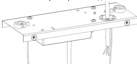
7. Пропустить тросики подвеса через отверстия крышки потолочной и завести свободные концы в грипферы установленные в корпусе светильника.
