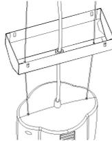
8. Змонтувати на опорну поверхню платік стельовий, попередньо завівши через прохідний ізолятор мережевий кабель.
