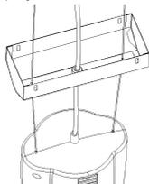
8. Смонтировать на опорную поверхность платик потолочный, предварительно заведя через проходной изолятор сетевую кабель.
