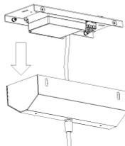
6. Установить в платик потолочный опоры и тросики подвеса из монтажного комплекта.
