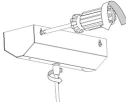
5. Сдвинуть крышку потолочную вниз по кабелю сетевому.
