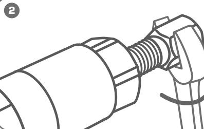
Вращая по часовой стрелке силовой болт ключом на 12 мм приведите в действие гайкомолом
