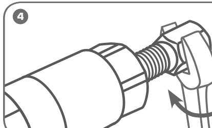
Вращая силовой болт против часовой стрелки ослабьте лезвие. Отвод лезвия производится вручную.
