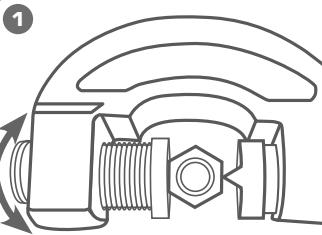
Установите гайку в рабочую область гайколома. Вращая регулировочный болт подведите гайку максимально близко к лезвию.
