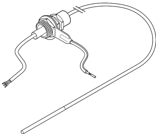
3-проводный датчик Pt 100 предназначен для использования во взрывоопасных зонах и комплектуется предварительно установленным на ввод кабеля датчика кабельным сальником (M16, сертифицирован EEx e, латунь, комплектуется уплотнительной шайбой, заземляющим отводом и контргайкой).
