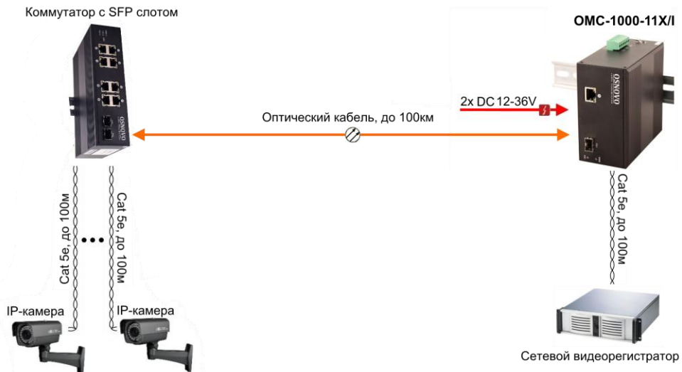
Рис.4 Типовая схема подключения медиаконвертера OMC-1000-11X/I
