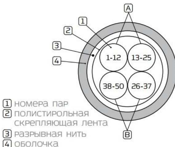
Рисунок 2 – Неэкранированный многопарный кабель U/UTP категории 3, 50 пар
