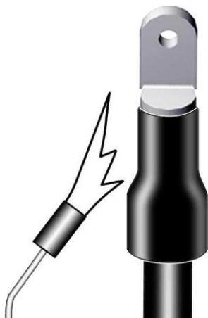
Обезжирить на каждой жиле цилиндрическую часть наконечника и трубку по жиле на длине 100 мм. Надвинуть на цилиндрическую часть наконечника трубку ТТШ для герметизации и усадить ее. После усадки по торцам трубок должен быть виден клей-расплав.
