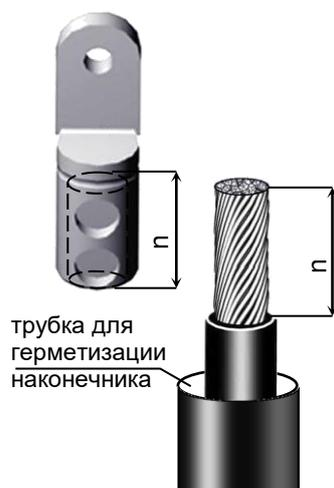
После остывания трубок надеть на каждую жилу трубку для герметизации наконечника. С каждой жилы снять фазную изоляцию на длине равной длине трубчатой части наконечника «п». Зачистить поверхности оголенных участков жил и произвести оконцевание жил наконечниками под опрессовку или наконечниками с контактными винтами со срывающимися головками.
