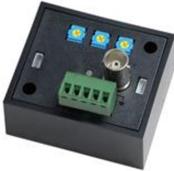
Рис.1 Приемник ТТА111HDR
