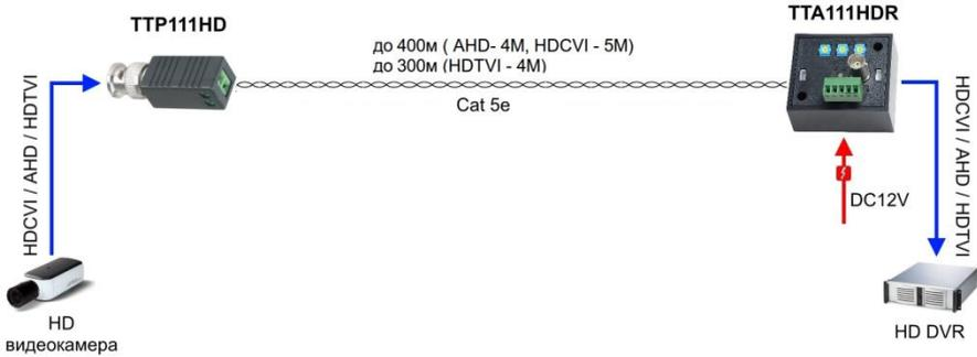
Рис. 4 Схема подключения приемника TTA111HDR к передатчику TTP111HD
