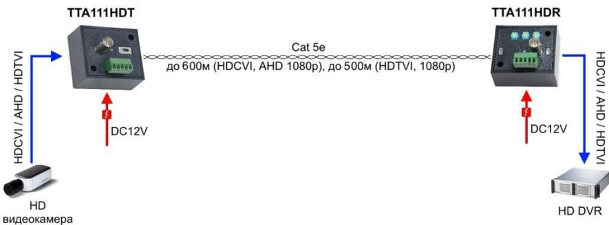
Рис. 5 Схема подключения приемника TTA111HDR к передатчику TTA111HDT
