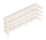
Кроссы 110 типа применяются для разделки на них кабелей различных подсистем СКС. Основным преимуществом 110 кроссов является возможность коммутации каждой отдельно взятой пары, что обеспечивает высокую гибкость переконфигурации кабельной системы. Соединение и коммутация осуществляется при помощи коннекторов 110 типа или соответствующих патч-кордов.
