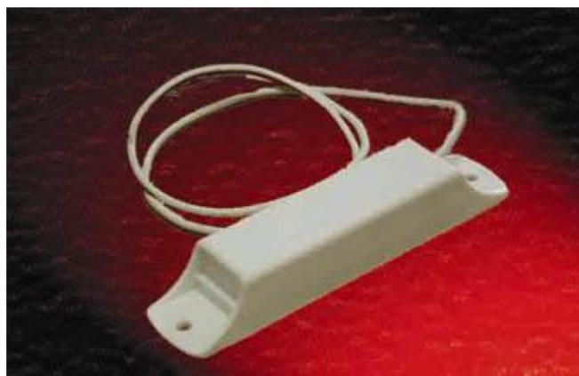
Извещатель конструктивно состоит из переключаемого геркона, совмещенного с магнитом находящихся в одном корпусе, изготовленном из ударопрочного полистирола. Извещатель реагирует на приближение магнитопроводящих металлов (сталь, пермаллой, оцинкованное железо и др.), ответной частью датчика является металлическая дверь или другая металлическая конструкция.
