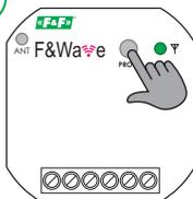
После подключения к сети питания приемника (исполнительного устройства F&Wave) нажать и удерживать кнопку PROG до тех пор, пока не включится нагрузка на выходе и погаснет индикатор связи с символом Y.
