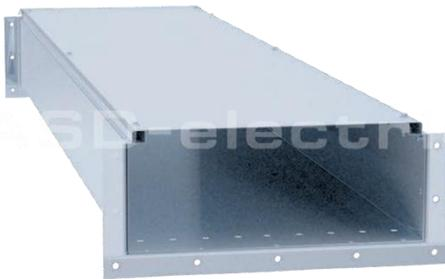
ККБ-ПО (Короб кабельный блочный прямой одноярусный) применяется при прокладке силовых кабелей до 10 кВ. В ККБ-ПО укладка кабеля производится на дно короба.
