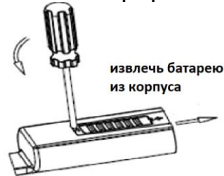
замена батареи рис.3
