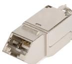
Коммутационные модули NIKOMAX с угловыми портами (серия «AN») относятся к системе Fast Termination и спроектированы специально для использования с инструментом для быстрой заделки NMC-FT-TOOL. Разведите кабель на контактах модуля, вставьте его в инструмент и просто сожмите рукоятки. Аккуратная и качественная заделка в одно нажатие! IDC контакты модулей AN также совместимы с обычным ударным инструментом с ножом 110 типа или KRONE.
