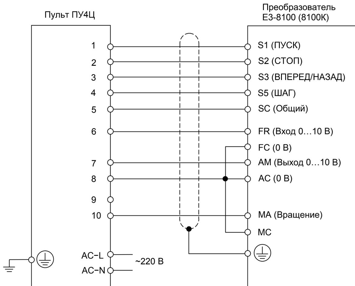
Программирование преобразователя частоты E3-8100 (8100К):
