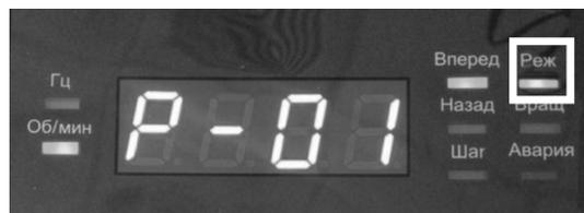
Редактирование параметров в Режиме настройки производится кнопками пульта в соответствии с их функциональным назначением (см. таблицу п.1):
