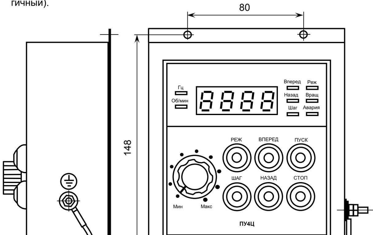
**10.3.** К клемме
