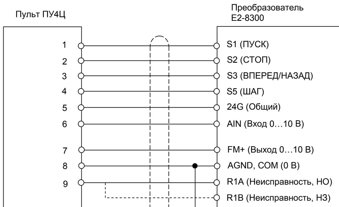
Программирование преобразователя частоты E2-8300:
