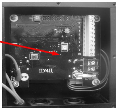
Установить ручку задания частоты на пульте ПУ4Ц в минимальное (нулевое) положение и нажать кнопку ПУСК.
