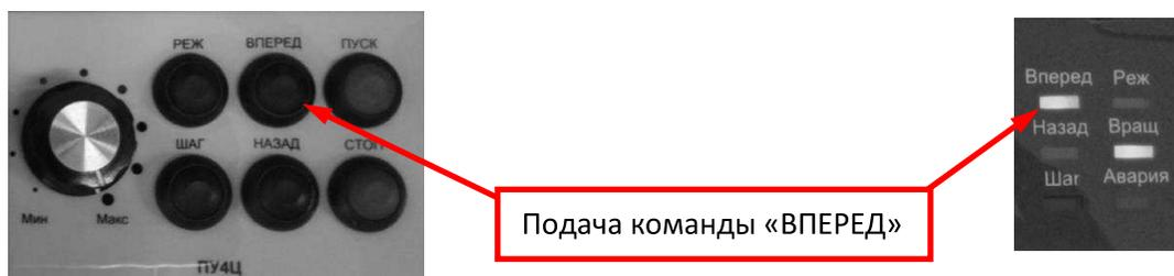
Изменение направления вращения двигателя производится нажатием кнопки НАЗАД на пульте (останавливать двигатель при этом не требуется). При этом на пульте загорается индикатор «Назад», преобразователь частоты плавно снижает скорость вращения до нуля, затем - сразу же плавно разгоняет его до заданной скорости в обратном направлении.
