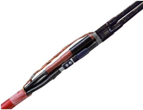
Проходные муфты типа СНМЗ подходят для всех трёхжильных кабелей в пластиковой изоляции с переходом на одножильные (PVC, PE, XLPE, EPR). Они позволяют производить соединение кабелей с различными поперечными сечениями, проводящими материалами, полупроводниками (с графитовым покрытием или удаляемыми) и экранами (проволочными или ленточными).
