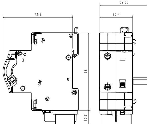
Изделие с удлинённым рычагом подсоединяется к аппарату шириной два модуля и более (BA 2P, 3P, 3P+N, 4P, 4P+N, 5P, 5P+N)
