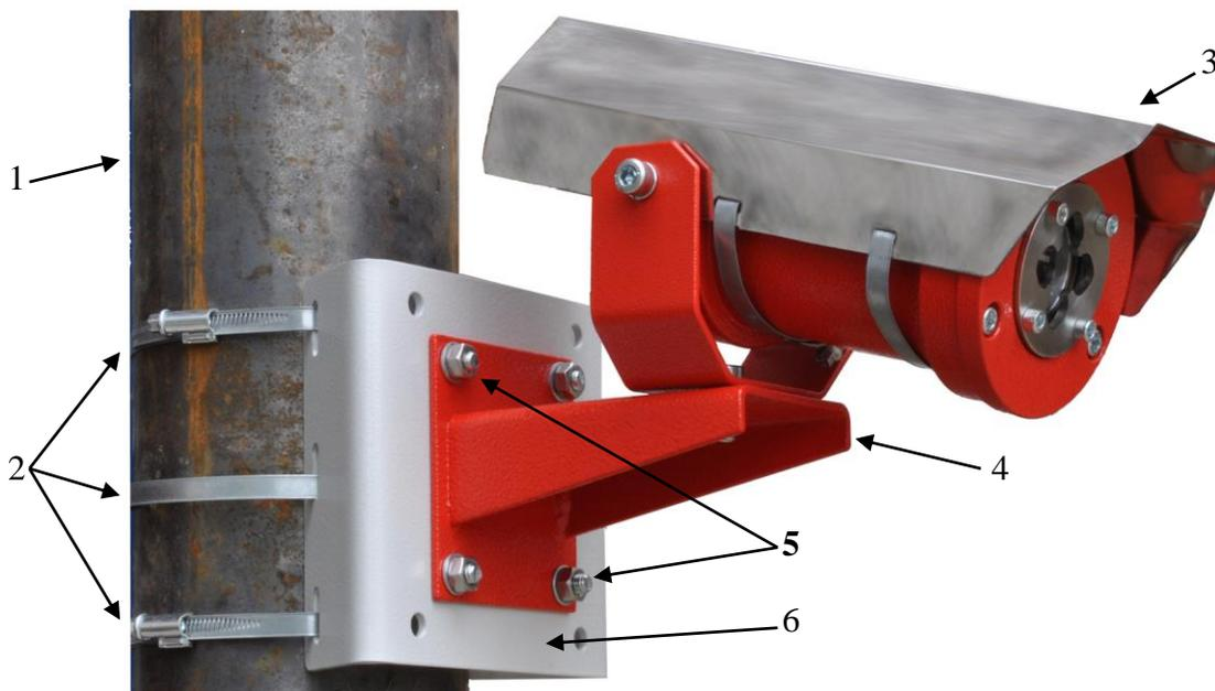
1 – столб или опора; 2 – хомут; 3 – оборудование; 4 – крепежно-юстировочное устройство; 5 – болт М8; 6 – скоба.
