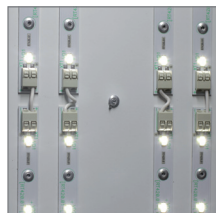
Равномерное распределение светодиодов
