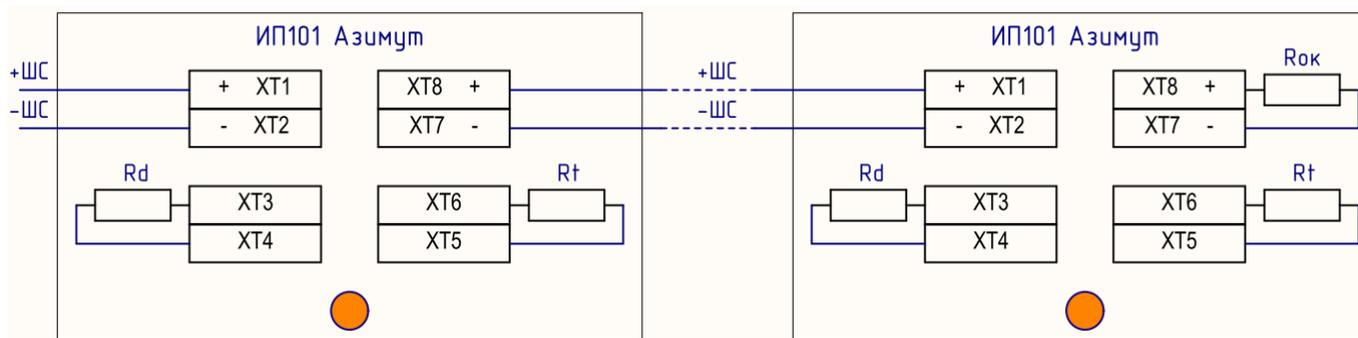
Rок – оконечный резистор, выбирается в соответствии с требованиями ПКП, допускается установка Rок внутри корпуса последнего извещателя в шлейфе;
