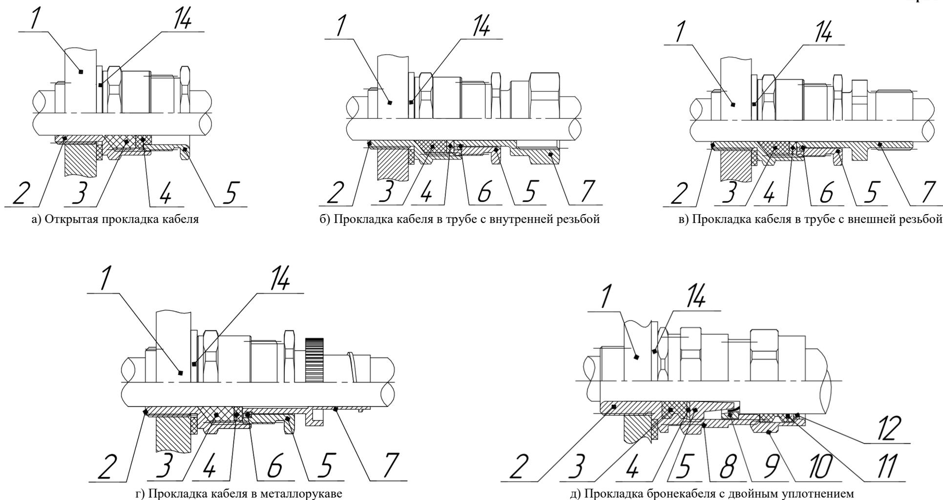
1 – Оболочка; 2 – Корпус ввода; 3 – Кольцо уплотнительное кабеля; 4 – Шайба нажимная; 5 – Гайка нажимная уплотнения кабеля; 6 – Кольцо стопорное; 7 – Штуцер; 8 – Гайка поджатия брони; 9 – Кольцо поджатия брони; 10 – Гайка нажимная уплотнения внешней оболочки бронекабеля; 11 – Кольцо уплотнительное внешней оболочки бронекабеля; 12 – Шайба упорная; 13 – Гайка торцевая; 14 – Шайба уплотнительная.
