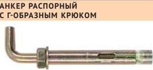
С Г-образным крюком. Используется для крепления тяжеловесных конструкций к полнотелому бетону, природному строительному камню, полнотелому кирпичу. Изготовлен из стали, поверхность оцинкована и пассивирована.
