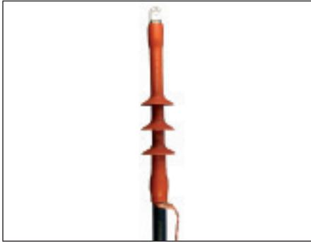
Концевые муфты типа CNE-F подходят для всех одножильных кабелей с пластиковой изоляцией (PVC, PE, XLPE, EPR) с различными типами полупроводников (с графитовым покрытием или удаляемых) и экранов (меднопроволочных или ленточных).
