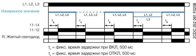
При наличии всех трех фаз и корректном чередовании фаз выходное реле активируется (контакт замкнут) после истечения времени выдержки при включении  $t_s$ . Если произошел обрыв фазы или нарушается последовательность чередования фаз, начинается отсчет времени выдержки при отключении  $t_v$ . По истечении времени выдержки выходное реле обесточивается (контакт разомкнут). Когда реле активировано светится желтый светодиод (СИД).
