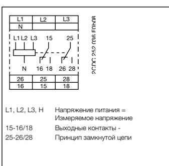
Схема подключения CM-MPN.x2
