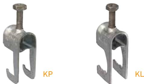
КР и КЛ – хомуты для кабеля, которые крепятся к направляющим и листовым структурам различного профиля. Хомуты горячеоцинкованы. Размер означает максимальный диаметр кабеля/трубы. Маркировка 26/2 означает, что кабельный хомут подходит для крепления двух кабелей диаметром 26мм. Хомуты для 3 кабелей поставляются под заказ.
