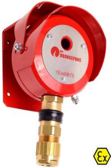
Извещатель пожарный пламени Тюльпан 2-18В предназначен для обнаружения электромагнитного излучения пламени в ультрафиолетовом диапазоне с максимумами спектральной чувствительности на  $\lambda=200$  нм и выдачи извещения о пожаре.
