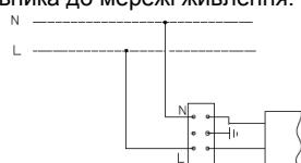
2. Схема підключення світильника до мережі живлення з регульованим драйвером по системі DALI .
