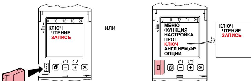
Загрузите программы из программного ключа в таймер (операция ЗАПИСЬ КЛЮЧ)
