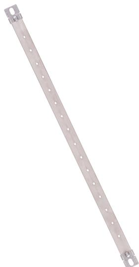
Шина заземления предназначена для вывода цепочки заземляющих контуров от всех токопроводящих частей шкафа, от установленного в шкафу оборудования и для подключения внешнего заземления. Шина имеет сечение 3x20 мм и выполнена из меди с антикоррозионным покрытием.
