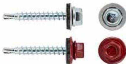
Стальные саморезы с шестигранной оцинкованной и цветной головкой со сверловидным наконечником, укомплектованные шайбой с резиновой прокладкой, для крепления кровельных материалов к деревянной обрешетке (диаметр самореза 4,8 мм) и к металлическим конструкциям (диаметр самореза 5,5 мм и 6,3 мм).
