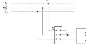
2. Шамдалдың резервтік қуаттандыру блогы бар қуаттандыру желісіне қосылу сыйбасы (суретте а - шамдал, б - резервтік қуаттандыру блогы).
