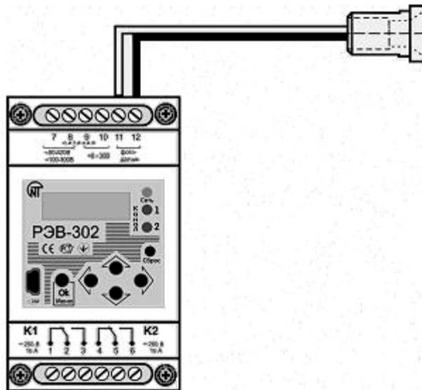
Рисунок 1.3 - Подключение фотодатчика к OptiDin PЭВ-302
