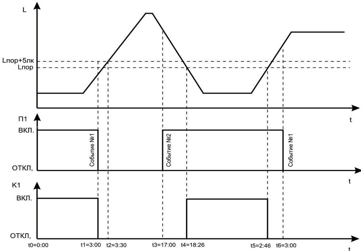
Рисунок 2.10 - Пример совместной работы реле времени и фотореле
