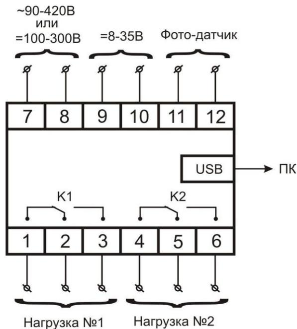
Рисунок 2.1 - Электрические соединения OptiDin PЭВ-302
