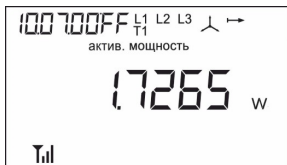
Рис. 11 Меню 10 кадр 1. Мощность активная всего, в Вт
