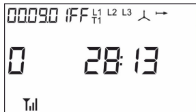
Рис. 15 Меню 11 кадр 3. Кадр ручной коррекции времени: 0 – коррекция запрещена, 1 – коррекция разрешена
