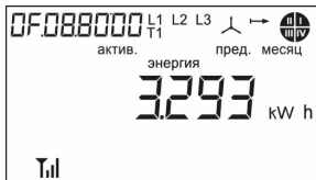
Рис. 9 Меню 1 Кадр 6. Энергия активная нарастающим итогом всего за предыдущий месяц, в кВт·ч
