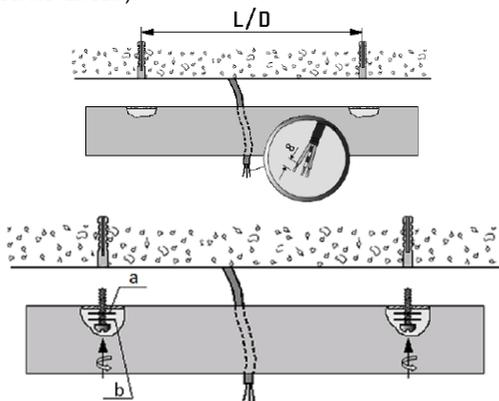
3. Підключити мережний провід до клемної колодки відповідно до зазначеної полярності.
