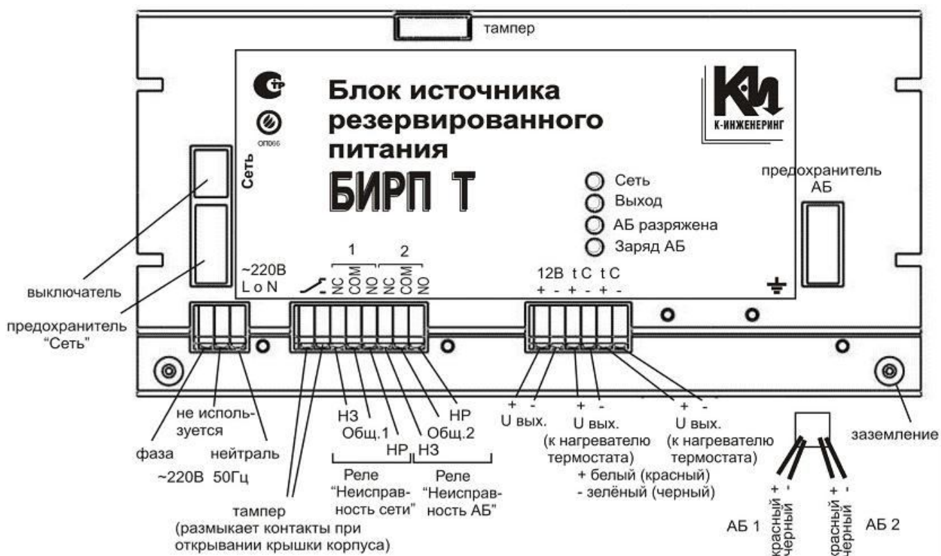
рис.3. Схема подключения.
