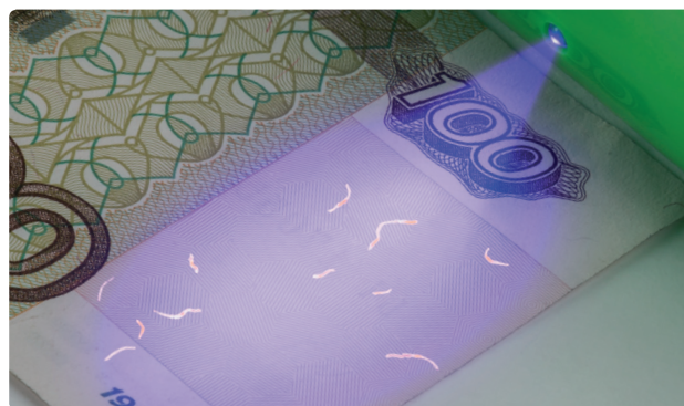
Ультрафиолетовая подсветка делает хорошо заметными люминесцентные защитные волокна
