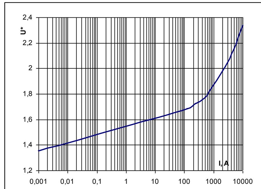
Примечание. Вольтамперная характеристика определялась экспериментально для диапазона токов:
