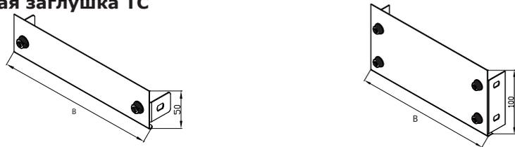
Используется для установки в торец лотка в местах окончания трассы. Состоит из одной пластины ТС, двух уголков FR соответствующих типоразмеров и крепежных элементов.
