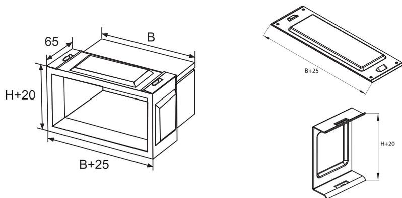
Позволяют осуществлять дополнительную степень защиты IP 44 в местах соединения неперфорированных лотков. Включает комплекты резинопластиковых уплотнителей и защитных металлических пластин. Для сохранения IP 44 при сверлении и креплении на консоли или профили рекомендуется использовать специальные резиновые шайбы или другие уплотнители, приобретаемые отдельно.
