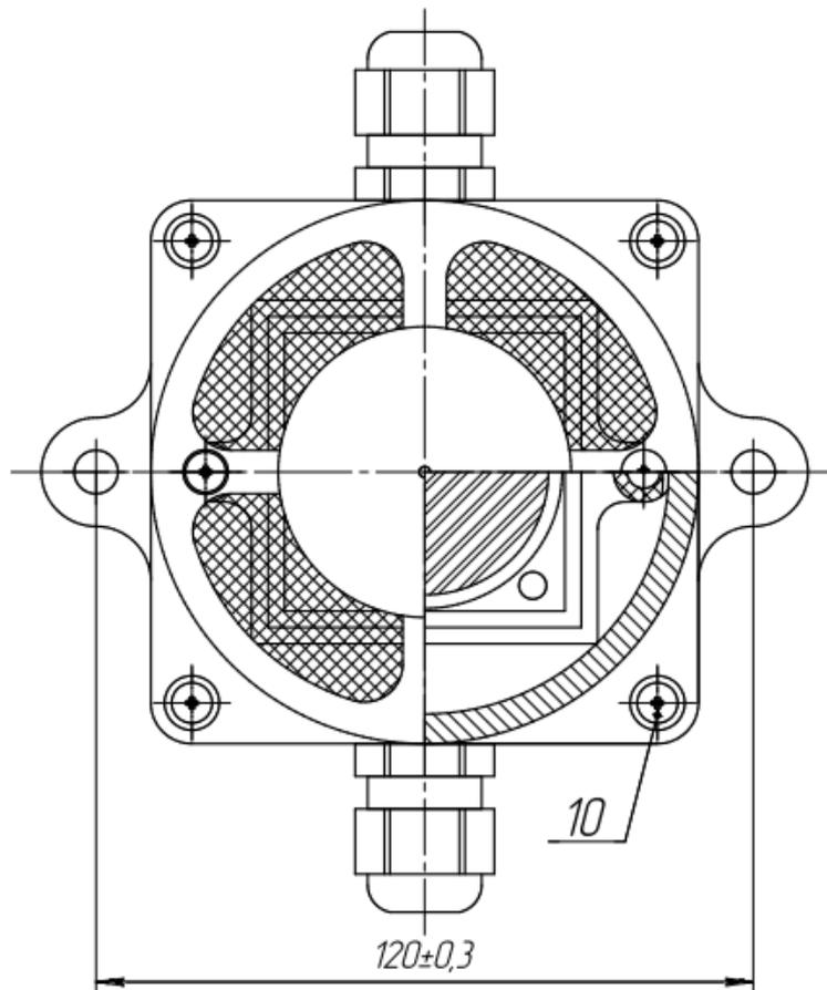
1 – датчик дыма; 2 – монтажная плата; 3 - основание; 5 - прокладка; 6 - корпус;
