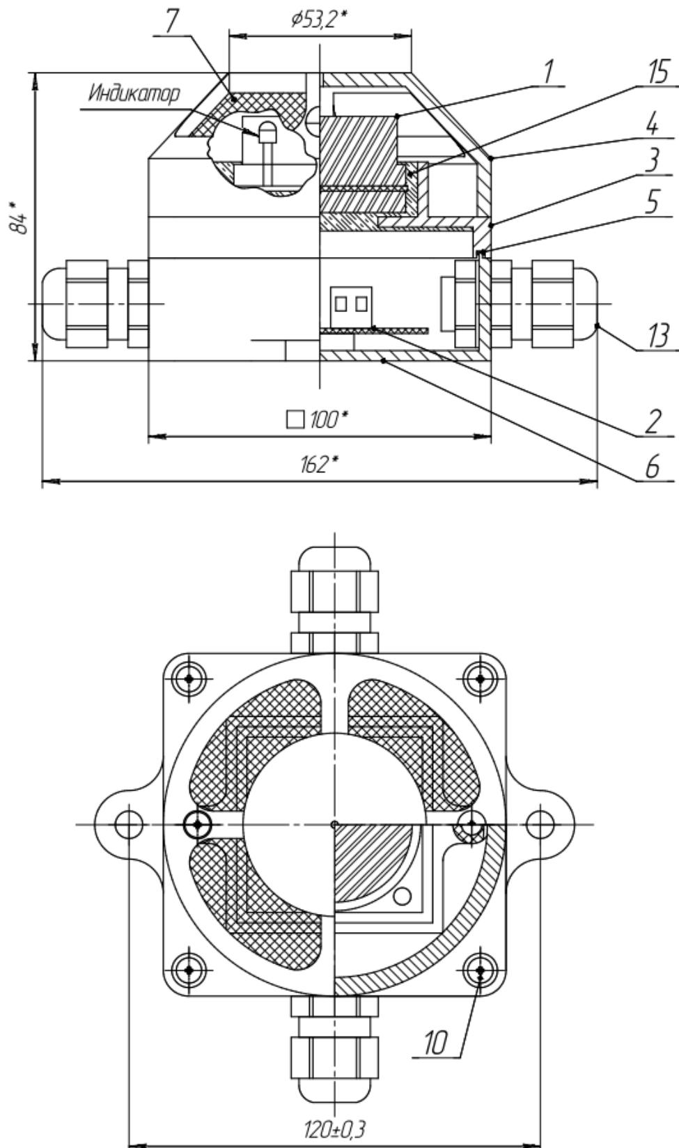
1 – датчик дыма; 2 – монтажная плата; 3 - основание; 5 - прокладка; 6 - корпус;
