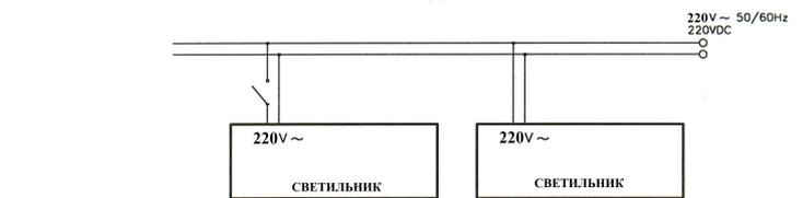
Рис. IV - Схема подключения светильников для централизованных систем питания.
